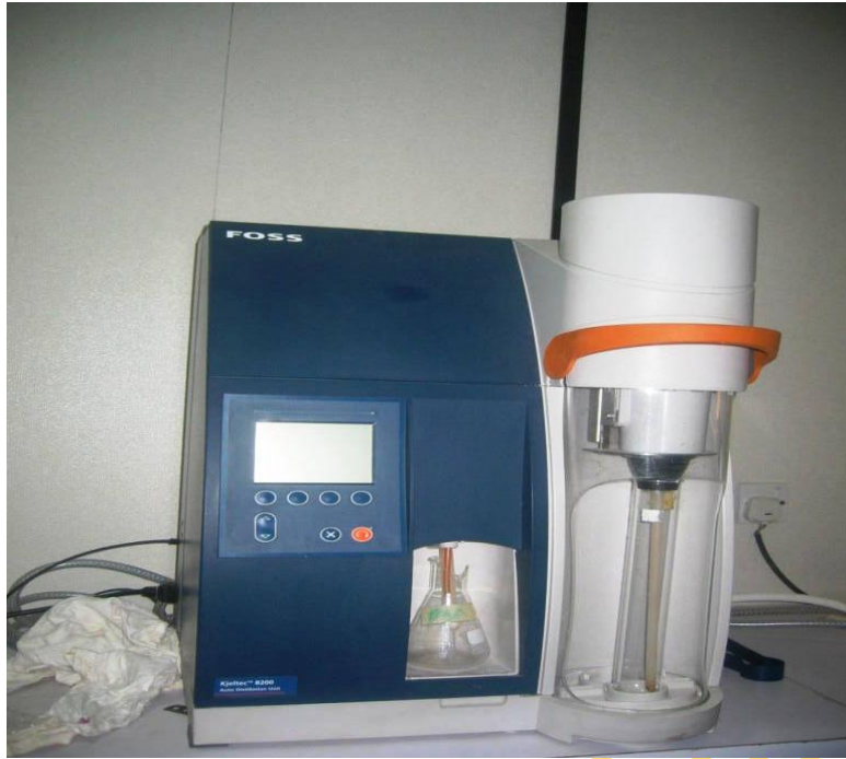
Plate 3.12: Distillation Unit (Kjeltec ™ 8200)
